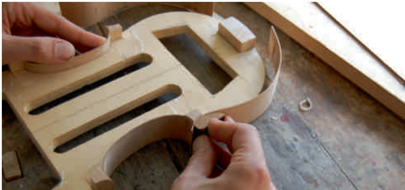
L'applicazione delle fasce agli zocchetti. Foto Luca Olzer
